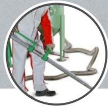
Optional mit Handsaugrohr mit Stützrädern und Handgriff.
