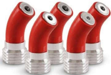
Winkeldüsen werden zum Strahlen von schwer zugänglichen Stellen wie Rohrrinnenwände oder Rückseite von Flanschen eingesetzt. BTC Winkeldüsen sind sehr kompakt und haben einen Austrittswinkel von 45°. Zum Strahlen von schwer zugänglichen Stellen. Hergestellt aus Wolframkarbid (TC). Passen zu allen Contracor Düsenhaltern.
