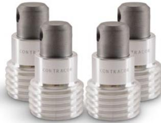
Winkeldüsen werden zum Strahlen von schwer zugänglichen Stellen wie Rohrrinnenwände oder die Rückseite von Flanschen eingesetzt. ATC Winkeldüsen sind sehr kompakt und haben einen Austrittswinkel von 45° zum Strahlen von schwer zugänglichen Stellen. Hergestellt aus Wolframkarbid (TC). Passen zu allen Contracor Düsenhalter.
